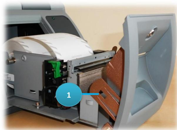
Abbildung 57: Druckereinheit des Wahlcomputers - Vordere Klemme öffnen.
