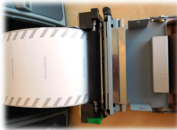
Abbildung 56: Druckereinheit des Wahlcomputers - Position des Papiers auf der Rolle.
