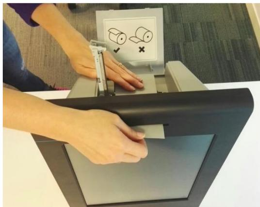
Abbildung 62: Papier mit grauer Seite nach oben durch den Schlitz.
