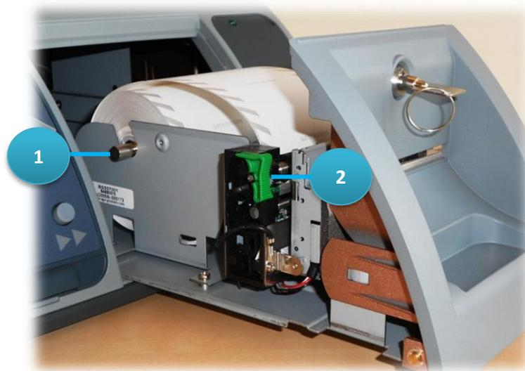
Abbildung 55: Druckereinheit des Wahlcomputers auf dem Schieber.
