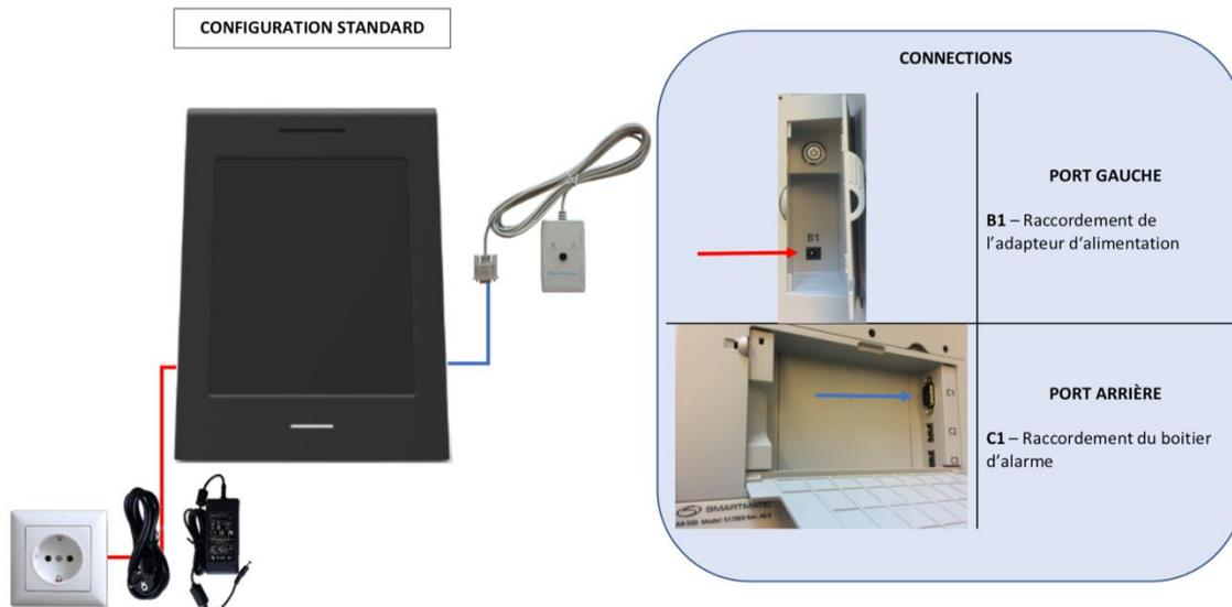
Figure 15 schéma d'installation d'un ordinateur de vote
