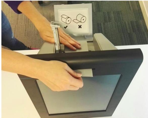
Figure 21 papier avec le côté gris vers le haut à travers la fente
