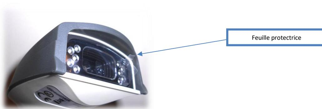
Figure 25 scanner à main avec feuille protectrice
