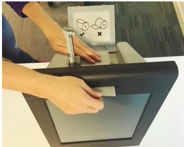
Figure 23 papier avec le côté gris vers le haut à travers la fente
